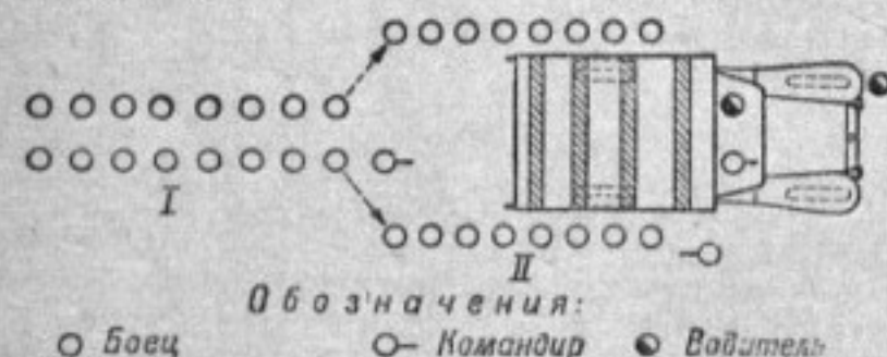
Рис. 8. Погрузка войск на полутонный автомобиль: 1 — положение войск при подходе к машине; 2 — положение войск перед погрузкой
